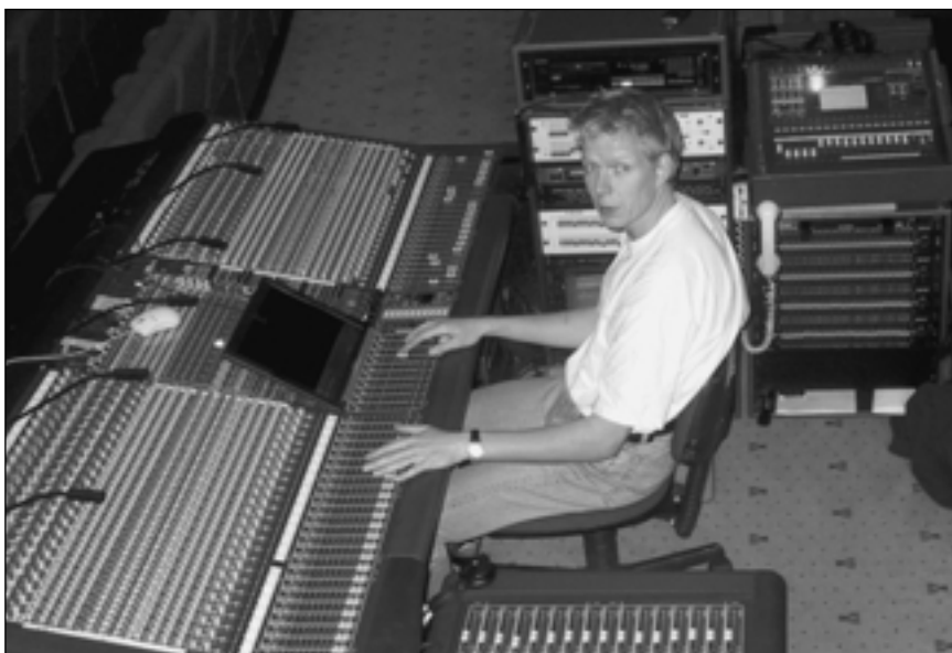
Front of House bij Titanic met technicus Stijn Wouters. Het zwarte paneeltje op de Midas, recht voor Wouters, is het Sony scherm waarop hij kan zien wie wanneer onder welke fader zit.
